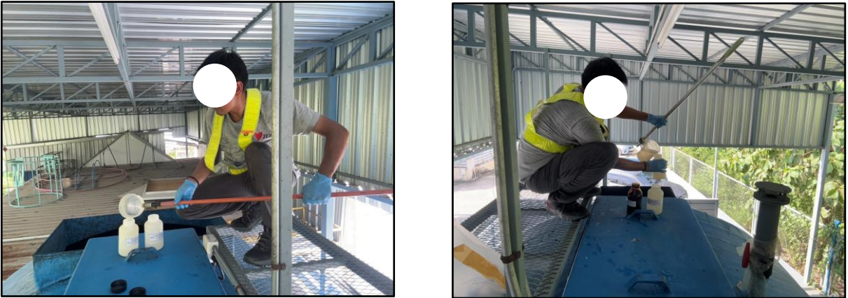
จุดเก็บตัวอย่างน้ำทิ้งหลังบำบัด (บ่อพักน้ำทิ้งของระบบบำบัดน้ำเสีย)
