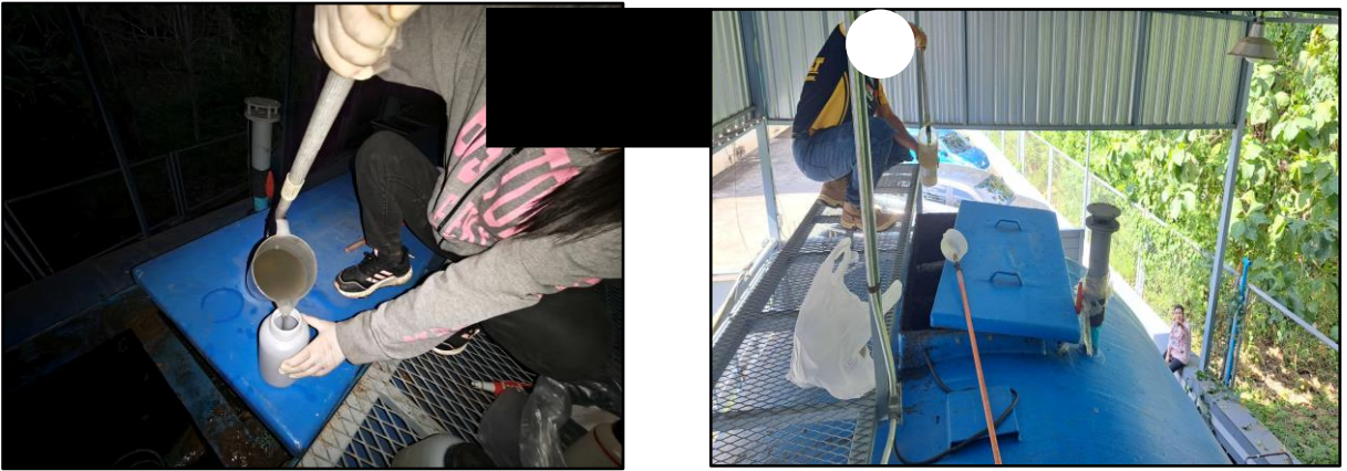
จุดเก็บตัวอย่างน้ำเสียก่อนเข้าระบบบำบัด (บ่อปรับสภาพน้ำเสีย)
