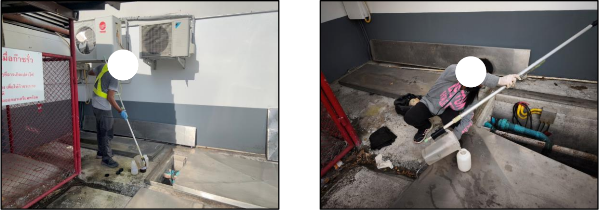
จุดเก็บตัวอย่างน้ำทิ้งที่บ่อพักน้ำทิ้งสุดท้าย (ก่อนระบายออกที่ระบายน้ำสาธารณะภายนอกโครงการ)
